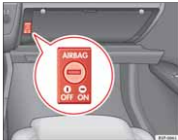
Obr. 26 V odkladacej priehradke je kľúčový spínač k deaktivácii a aktivácii airbagu spolujazdca.
