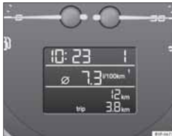
Obr. 43 Digitálny displej v paneli prístrojov: ukazovateľ priemernej spotreby paliva
