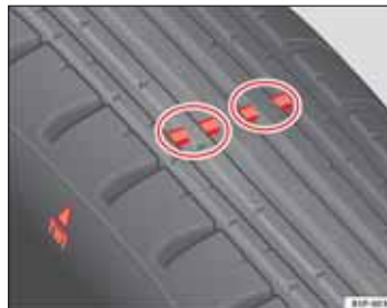
Obr. 172 Detail profilu pneumatiky: Indikátory opotrebovania
