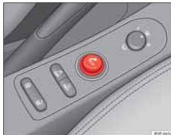
Obr. 116 Zapaľovač je umiestnený v elektrickej zásuvke prednej stredovej konzoly.
