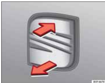
Obr. 64 Dvere batožinového priestoru: Otváranie zvonku
