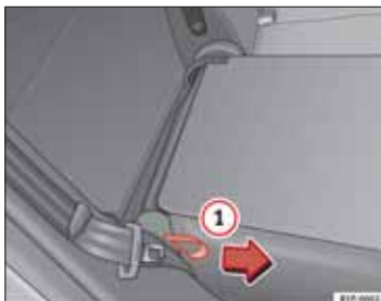
Obr. 98 Sklopenie, resp. vyklopenie operadla zadného sedadla.
