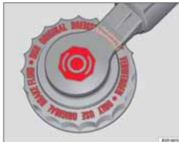
Obr. 171 V motorovom priestore: Veko nádržky brzdovej kvapaliny
