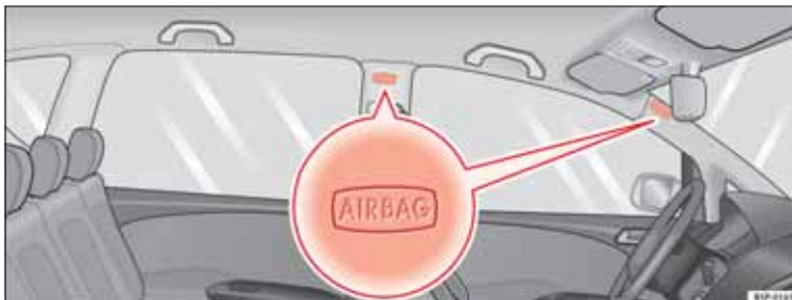
Obr. 24 Umiestnenie hlavového airbagu na ľavej strane vozidla.
