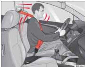
Obr. 11 Pripútaný vodič, ktorého zachytáva správne zapnutý bezpečnostný pás pri prudkom brzdení.
