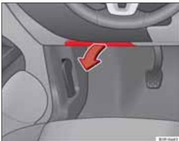
Obr. 182 Vľavo v prístrojovej doske: Kryt poistkovej skrinky
