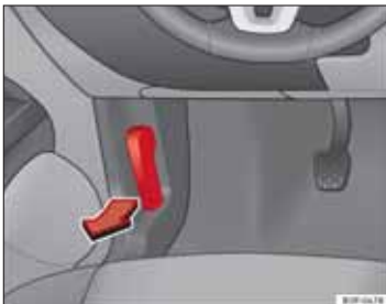
Obr. 161 Detail priestoru pre nohy vodiča: Páčka na odistenie veka motorového priestoru
