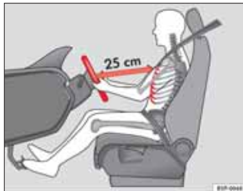
Obr. 1 Správna vzdialenosť vodiča od volantu
