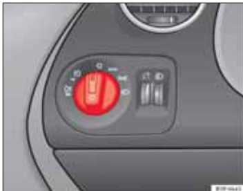
Obr. 71 Detail prístrojovej dosky: spínač hlavných svetiel, hmlových svetiel a kontrolka zadného hmlového svetla.
