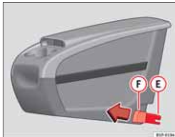
Obr. 111 Odnímateľná odkladacia priehradka: Montáž
