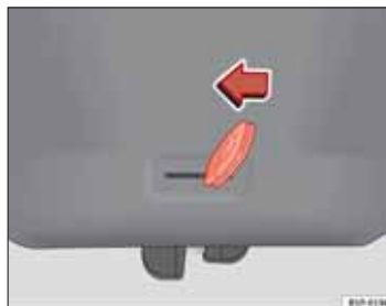
Obr. 66 Dvere batožinového priestoru: Núdzové otváranie
