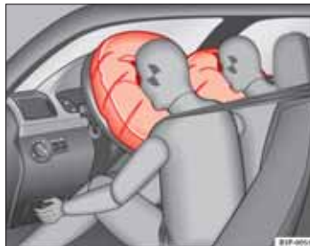
Obr. 20 Naplnené čelné airbagy.
