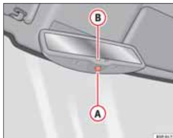
Obr. 88 Vnútorne zrkadlo s automatickou clonou proti oslneniu
