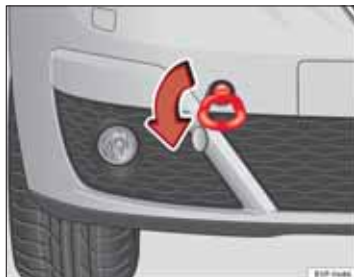
Obr. 204 Predná pravá časť vozidla: zaskrutkovanie predného ťažného oka
