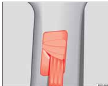
Obr. 17 Umiestnenie mechanizmu pre nastavenie výšky
