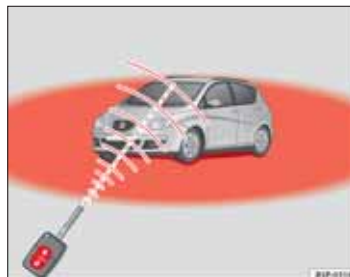
Obr. 63 Dosah rádiového diaľkového ovládania
