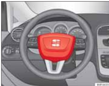
Obr. 18 Umiestnenie airbagu vodiča vo volante.
