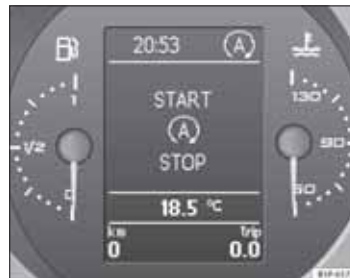
Obr. 140 Zobrazenie na displeji panelu prístrojov počas aktívnej funkcie Start-Stop
