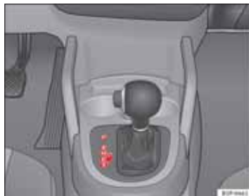
Obr. 143 Časť stredovej konzoly: polohy páky predvoľby u vozidiel s automatickou prevodovkou / automatickou prevodovkou DSG
