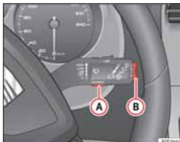
Obr. 44 Ovládacia páčka stieračov a ostrekovačov: Tlačidlo A pre potvrdenie jednotlivých bodov menu a výkyvný spínač B pre zmenu menu.
