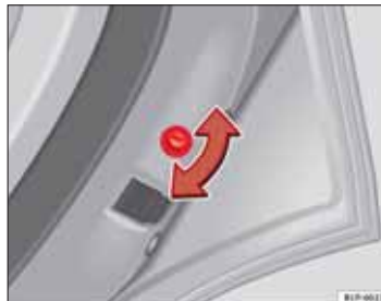
Obr. 60 Detská poistka v pravých zadných dverách
