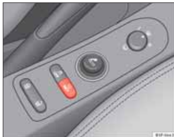
Obr. 49 Stredová konzola: Tlačidlo systému kontroly tlaku v pneumatikách.
