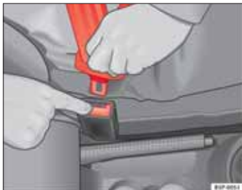
Obr. 16 Uvoľnenie jazýčka zo zámku pásu
