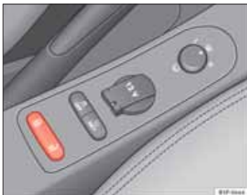
Obr. 57 Detail stredovej konzoly: tlačidlo centrálneho uzamykania.
