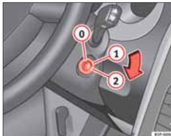
Obr. 137 Polohy zámku spínacej skrinky
