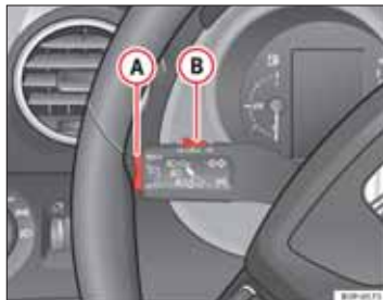
Obr. 152 Ovládacia páčka smerových a stretávacích svetiel: Spínač a výkyvný spínač tempomatu.
