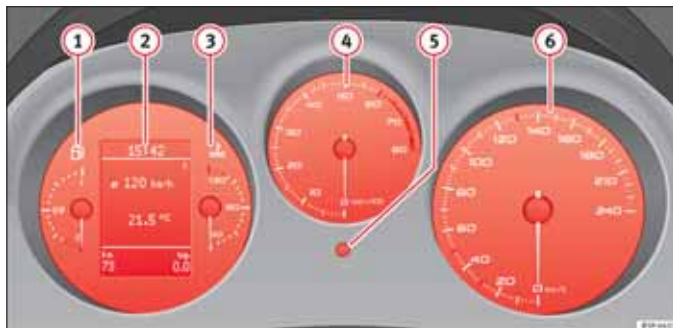
Obr. 33 Detail panelu prístrojov: Prístroje.
