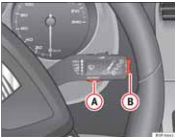
Obr. 46 Ovládacia páčka stieračov a ostrekovačov (MFD): Tlačidlo A pre potvrdenie jednotlivých bodov menu a výkyvný spínač B pre zmenu menu.
