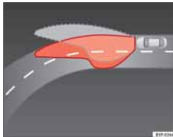
Obr. 74 Osvetlenie zákruty pomocou smerových svetlometov. ▶
