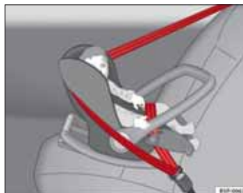
Obr. 28 Detská sedačka kategórie 0, v ktorej dieťa sedí chrbtom proti smeru jazdy, upevnená na zadnom sedadle.
