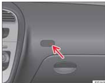
Obr. 27 Kontrolka deaktivácie airbagu spolujazdca na streďovej konzole.
