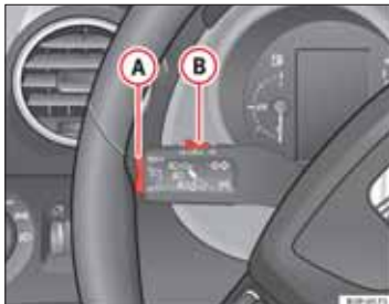
Obr. 154 Ovládacia páčka smerových a stretávacích svetiel: Spínač a výkyvný spínač tempomatu.
