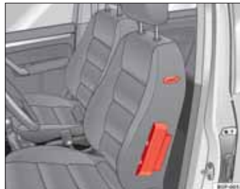
Obr. 22 Bočný airbag v sedadle vodiča.
