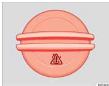
Obr. 166 V motorovom priestore: Veko expanznej nádržky chladiacej kvapaliny
