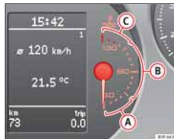
Obr. 35 Detail panelu prístrojov: Ukazovateľ teploty chladiacej kvapaliny.
