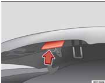
Obr. 162 Poistná západka veka motorového priestoru
