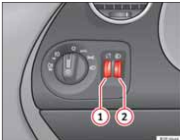
Obr. 73 Detail prístrojovej dosky: Ovládač osvetlenia panelu prístrojov a ovládač sklonu svetlometov.
