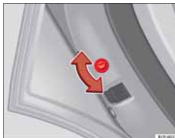
Obr. 59 Detská poistka v ľavých zadných dverách
