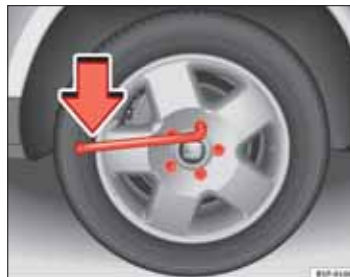
Obr. 176 Výmena kolesa: Uvoľnenie skrutiek kolies
