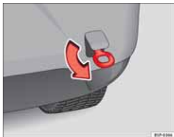
Obr. 205 Zaskrutko- vanie zadného ťažné- ho oka
