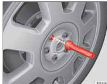
Obr. 180 Výmena kolesa: Nástrčkový kľúč v rukoväti skrutkovača na odskrutkovanie skrutiek kolies
